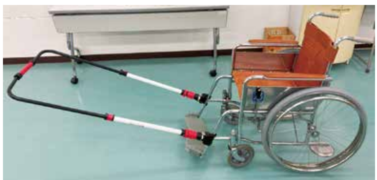
Fig. 2 人力車アタッチメントを装着した車椅子
